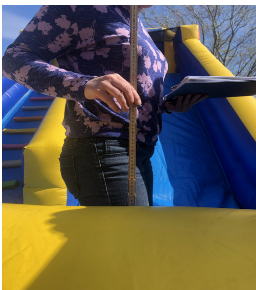
För låga stoppväggar efter rutschbanor.
