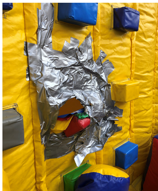
Stort hål i klättervägg på hoppborg.
