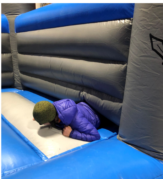
Öppningar mellan vägg och golv där barn kan komma igenom med kroppen men inte med huvudet och riskera att fastna och bli hängande.
