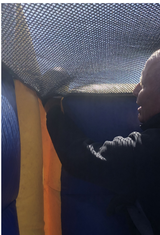
Öppning högst upp på plattformen till en rutschbana där barn kan komma igenom med hela kroppen och falla ned från hög höjd.
