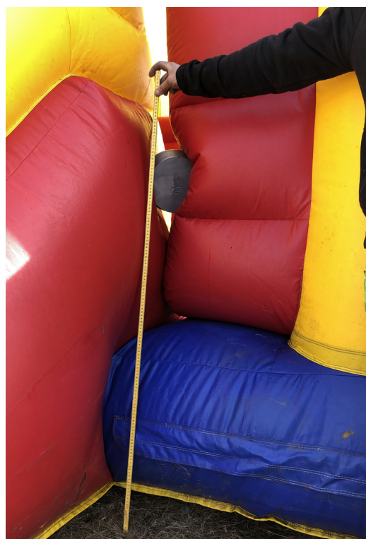
Öppning där barn kan komma igenom med kroppen men inte med huvudet och fastna och bli hängande i huvudet
