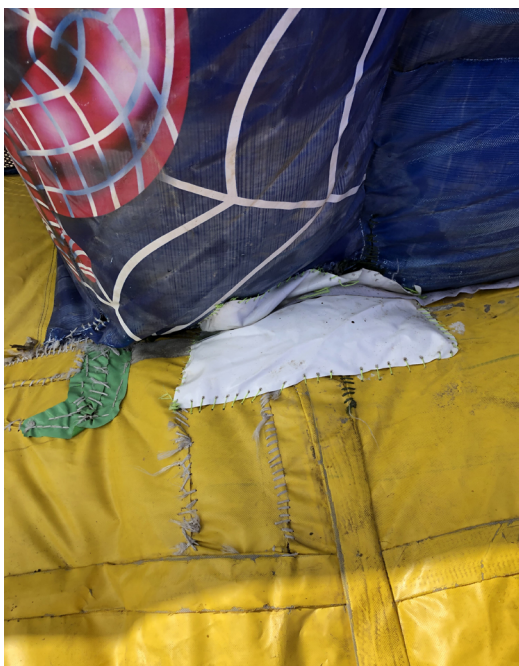
Lagningar i en rutschbana som skapar vassa kanter som barn kan riva sig på.
