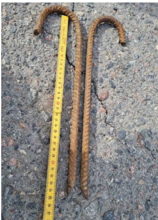
För korta förankringsspett
