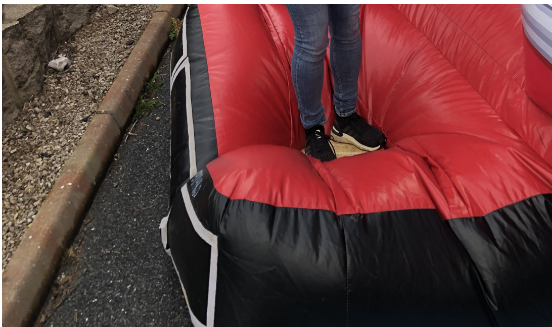
Test där person bottnar på entrékudden vilket medför risk för att hoppare kan slå emot hårt underlag genom borgen.
