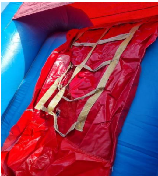
Klätternät med öppningar som barn kan komma igenom med kroppen och fastna och bli hängande i huvudet.
